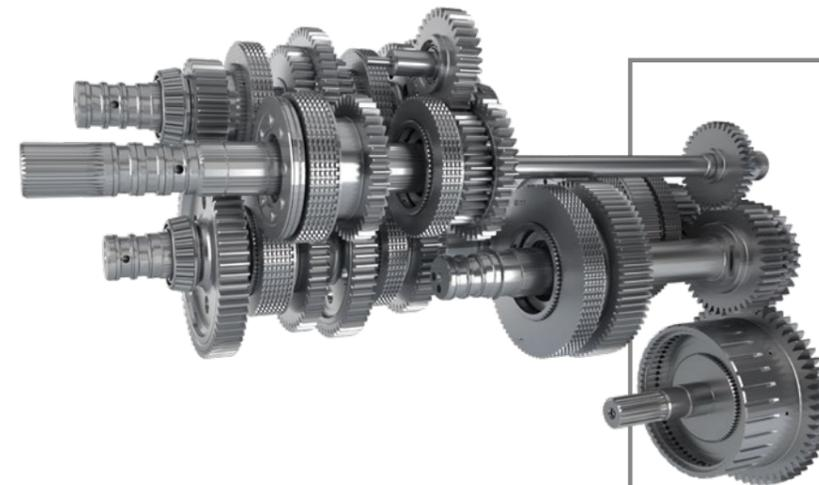
10 marchas con cambio asistido en el grupo de 5-16 km/h para la máxima potencia de tiro en el campo a las revoluciones más adecuadas. La velocidad máxima se alcanza a 1.500 r/min (40 km/h) o 1.800 r/min (50 km/h) para un ahorro óptimo del combustible.
